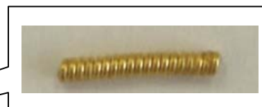
内部に装填されているコイル
