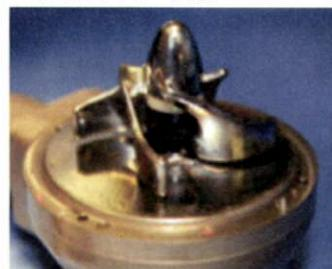
三次元形状のポンプ回転翼が血液の高流量を実現。血液ポンプにはミスズ工業の精密加工技術を応用。
