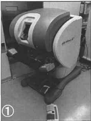
① 手術者がお腹の中の様子を見ながら手術の操作を②に伝える操作ボックス
