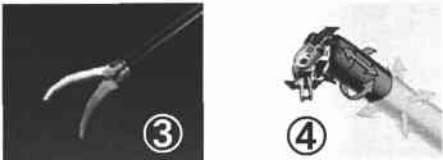
③ 腹腔鏡の器具の先端は可動しないが da Vinciの器具の約1cmの先端(④)は人間の手よりも広い稼働範囲を持つ
